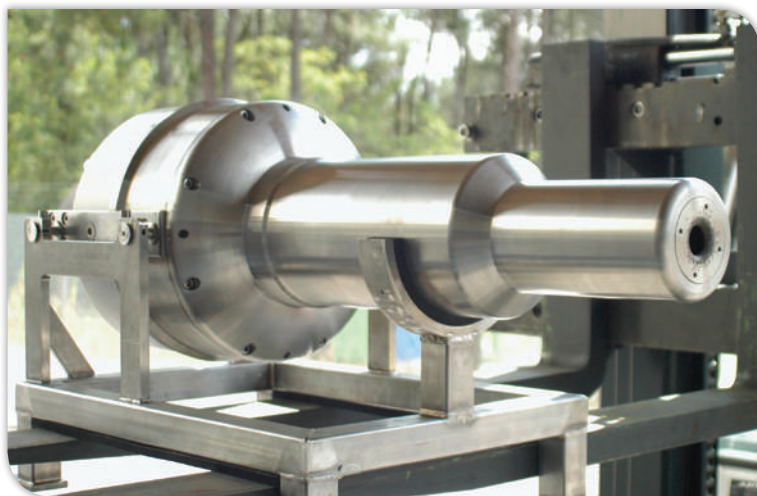
Torche à plasma à arc non-transféré (300KW)
